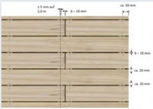
Abstände und Toleranzen von Fugen und Verschraubungen
